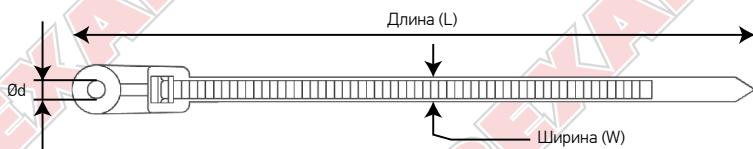
2. Диаметр обхвата стяжкой пучка кабелей максимальный (в миллиметрах).
