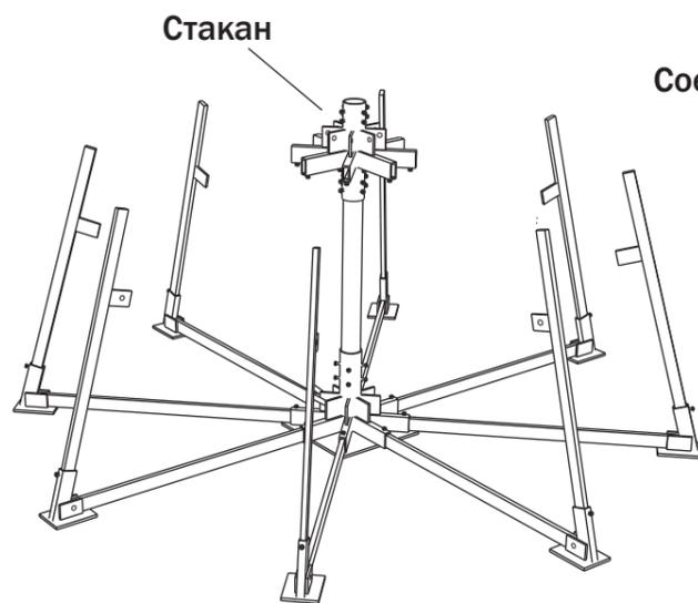
7 В стакан вставить горизонтали. Закрепить соединители на диагоналях сверху, каждую из которых соединить с горизонталями.
