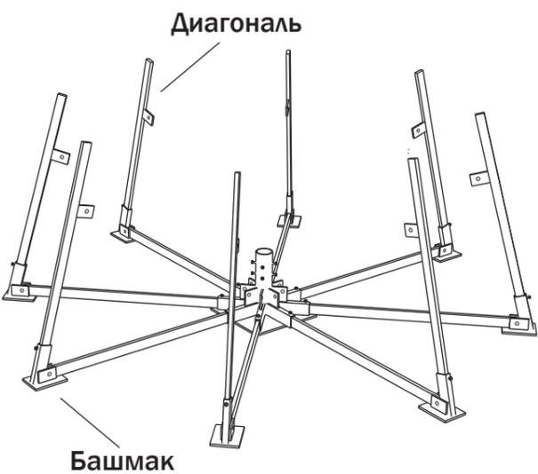
5 В опорную плиту установить ствол. Закрепить.
