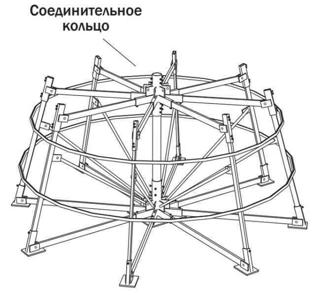
**10** Установить пригруз в виде бетонных блоков (в комплект поставки не входят), равномерно распределив его на горизонталях.
