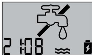
Запрет вращения кранов будет снят через 3 минуты. Если за это время датчик просохнет, то после 3-минутной задержки контроллер перейдет в штатный режим работы. Если за это время датчик не просохнет, то контроллер опять перекроет краны по аварийному событию.
