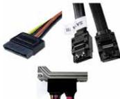
Рис. 1 Подключенные разъемы к HDD
