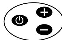
7. Управляйте яркостью работающих диодов с помощью сенсорных кнопок блока управления: «+» – увеличение яркости, «-» – уменьшение яркости.
